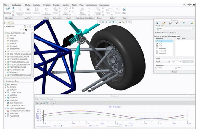
Mit Mechanism Design können Sie mechanische Verbindungen erstellen und Bewegungen an kinetischen Baugruppen simulieren.
