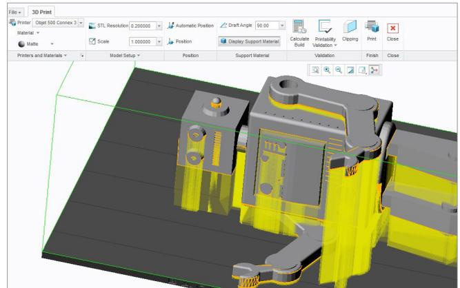
Das Modell wird auf der Druckablage positioniert und das benötigte Supportmaterial in Creo angezeigt.
