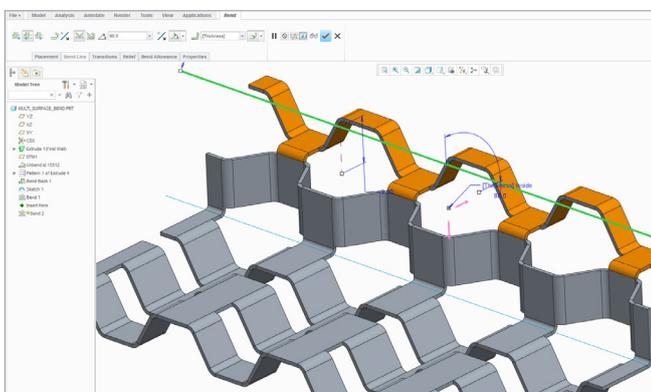
Erzeugen Sie Blechgeometrie mithilfe von Funktionen für automatische Biegeentlastungen, Blechrippen, koplanare Geometriebiegungen usw.
